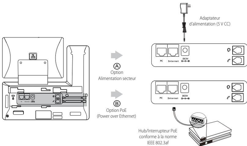
Remarque : Le téléphone IP doit uniquement être utilisé avec l'adaptateur d'alimentation Yealink (5 V/2 A). L'utilisation d'un adaptateur d'alimentation tiers est susceptible d'endommager le téléphone.
