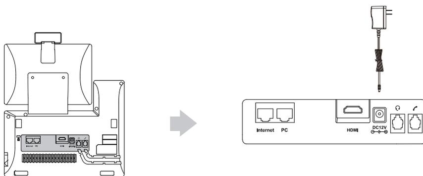
Remarque : Le téléphone IP doit être utilisé uniquement avec l'adaptateur d'alimentation fourni par Yealink (12V/2A). L'utilisation d'un adaptateur secteur tiers peut endommager le téléphone.
